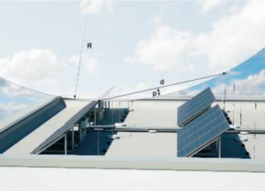
p = глубина проникновения, R = радиус сферы вращения, d = расстояние между молниеприемными стержнями
