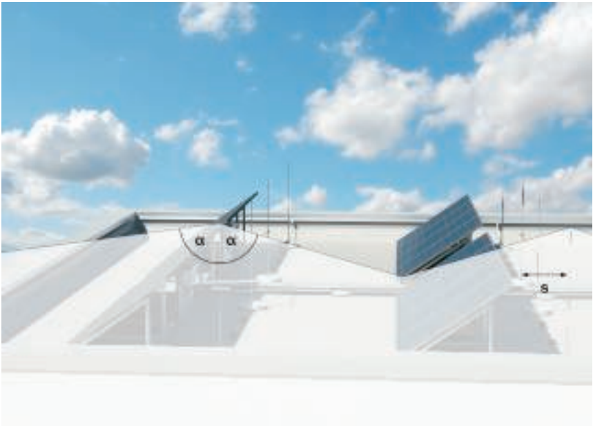
\alpha^\circ = защитный угол, s = разделительный интервал
